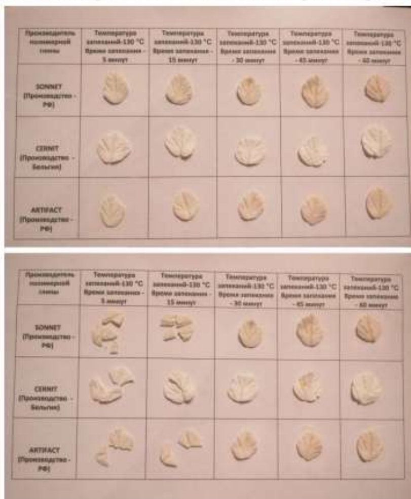
Рисунок 3 – Изменение цвета и прочности изделия из полимерной глины, в зависимости от времени запекания
